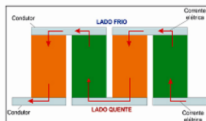
Figura 1. Princípio de conversão direta de calor em energia elétrica
